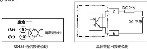
接线如有变动, 以实际设备机壳上的接线图为准
